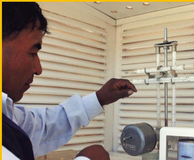
Para mediciones de temperatura del aire se requieren dos termómetros: uno es el termómetro de máxima que permite medir la temperatura más alta registrada durante el día; el otro es el termómetro de mínima que nos indica la temperatura más baja.
