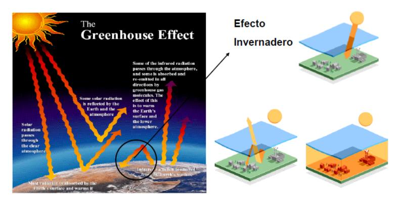
El efecto invernadero se produce en la atmósfera de forma natural debido a la presencia de vapor de agua, CO<sub>2</sub> y otros gases de efecto invernadero. Este efecto 'natural' es de responsable de que la temperatura en la superficie de la tierra sea 30°C superior a la que correspondería si no existiesen dichos gases
